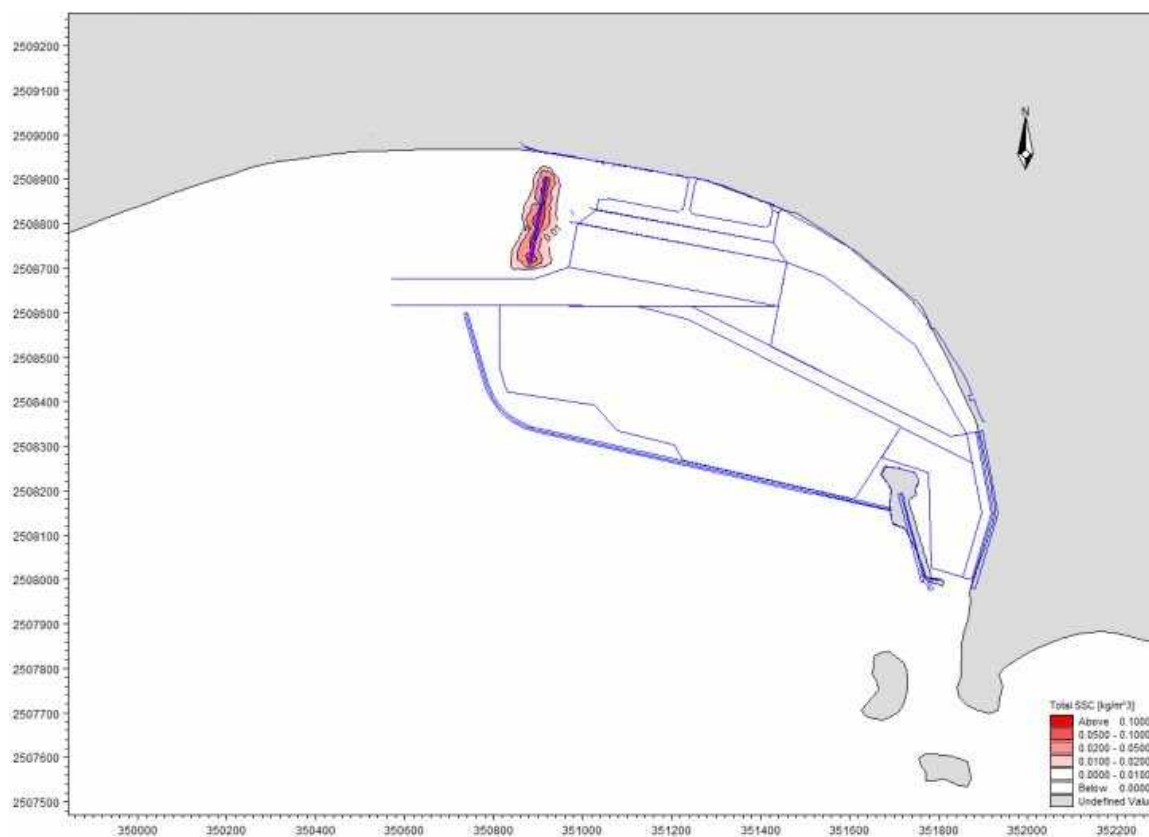
图 8.3.3-2 拦砂堤施工产生悬沙增量包络线图
